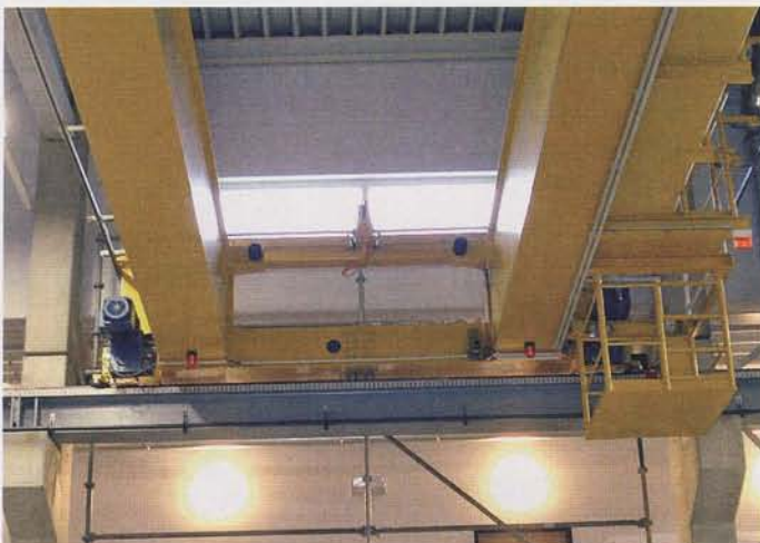
Bild 3: Umgebauter Kopfträger Außenbahn mit Lenkantrieb
