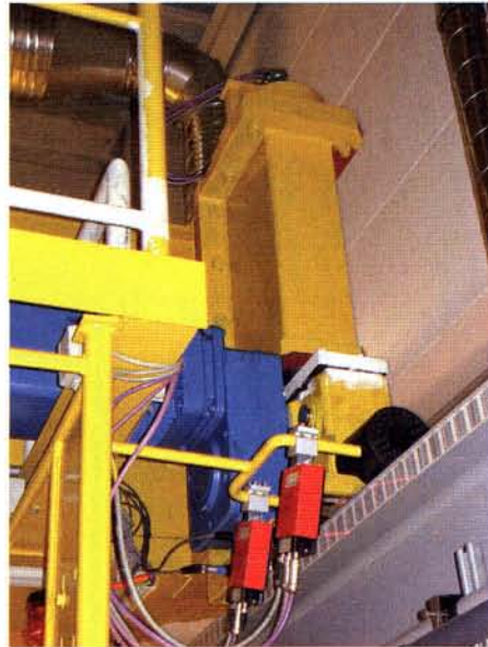
Bild 1: Links zu sehen das Einachs-Drehgestell mit US-Sensoren und Barcodeslern und rechts ein Blick von außen auf das Einachs-Drehgestell (oben der Drehgeber zu erkennen)
